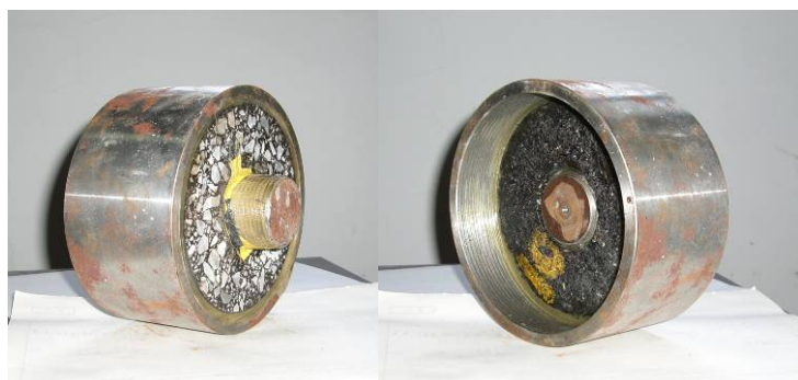
图 2 同轴剪切试验试件
