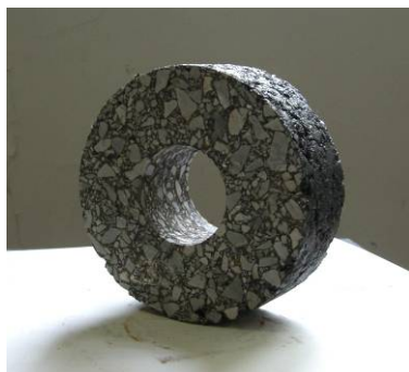
图 1 试验用中空圆柱体试件
